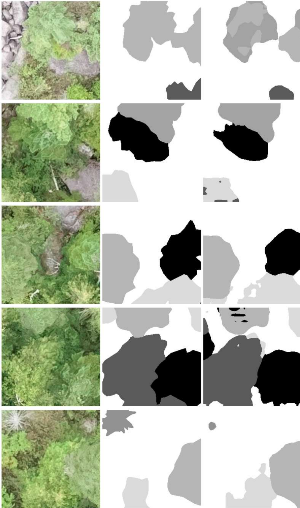
Fig. 4.20: Resultados esperados y obtenidos utilizando una DeepLabV3 con un backbone de ResNet50 y un scheduler ReduceLROnPlateau().
